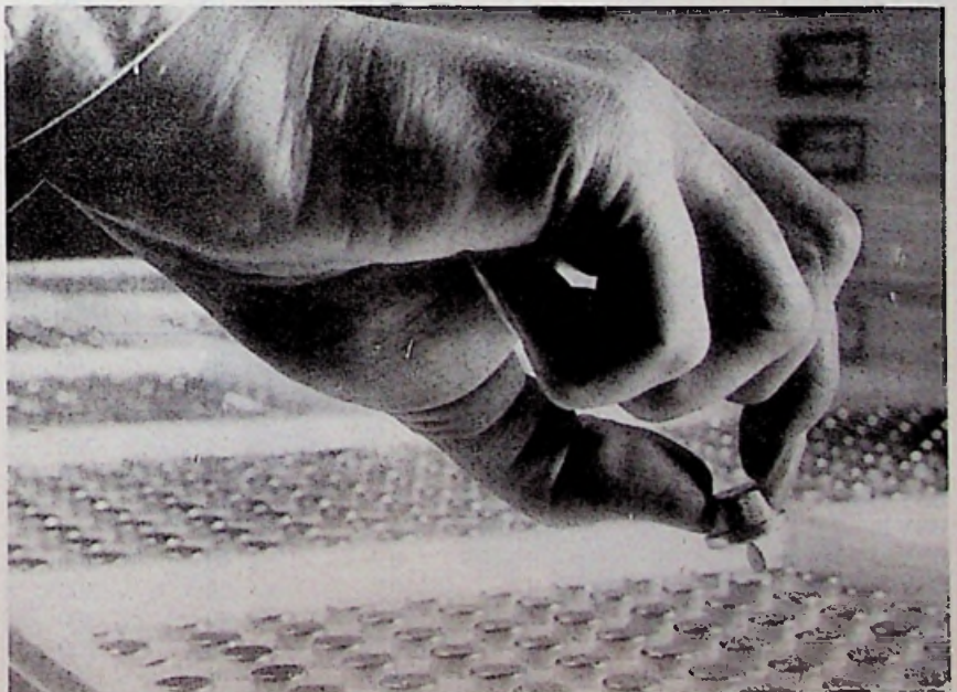
Vermogensdioden voor automobielen. Deze dioden dienen om de wisselstroom van de dynamo om te zetten in een gelijkstroom voor het laden van de accu. (Siemens)
